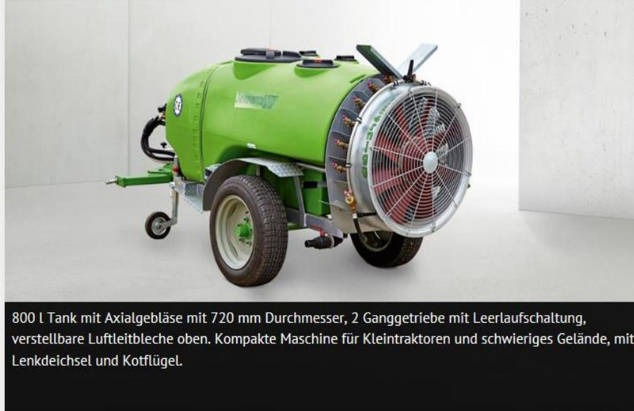
800 l Tank mit Axialgebläse mit 720 mm Durchmesser, 2 Ganggetriebe mit Leerlaufschaltung, verstellbare Luftleitbleche oben. Kompakte Maschine für Kleintraktoren und schwieriges Gelände, mit Lenkdeichsel und Kotflügel.
